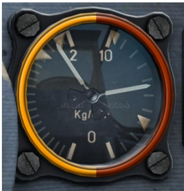
Рисунок 37: Топливный манометр (левая шкала)
