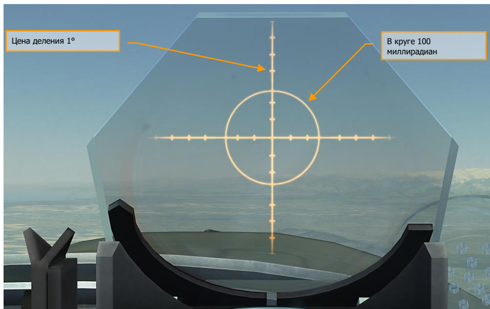
Рисунок 64: Прицельная сетка Rev 16B
