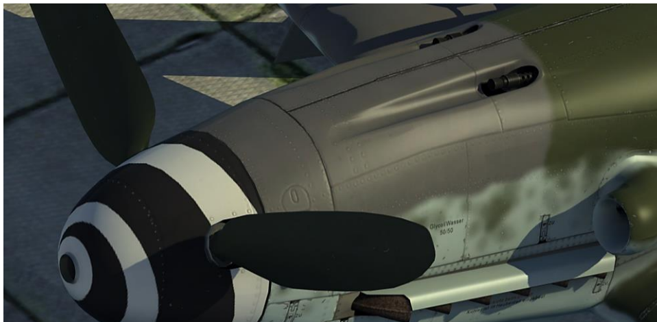
Рисунок 52: Мотор-пушка МК 108 и два пулемета MG 131 над двигателем
