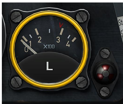
Рисунок 36: Топливомер и лампа аварийного остатка топлива
