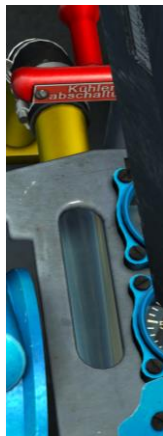
Рисунок 97: Индикатор подачи топлива из подвешного бака
