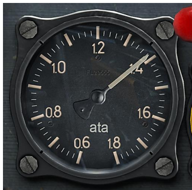
Рисунок 29: Указатель давления наддува
