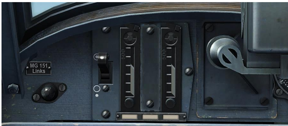
Рисунок 53: Счетчик боеприпасов SZKK 3
