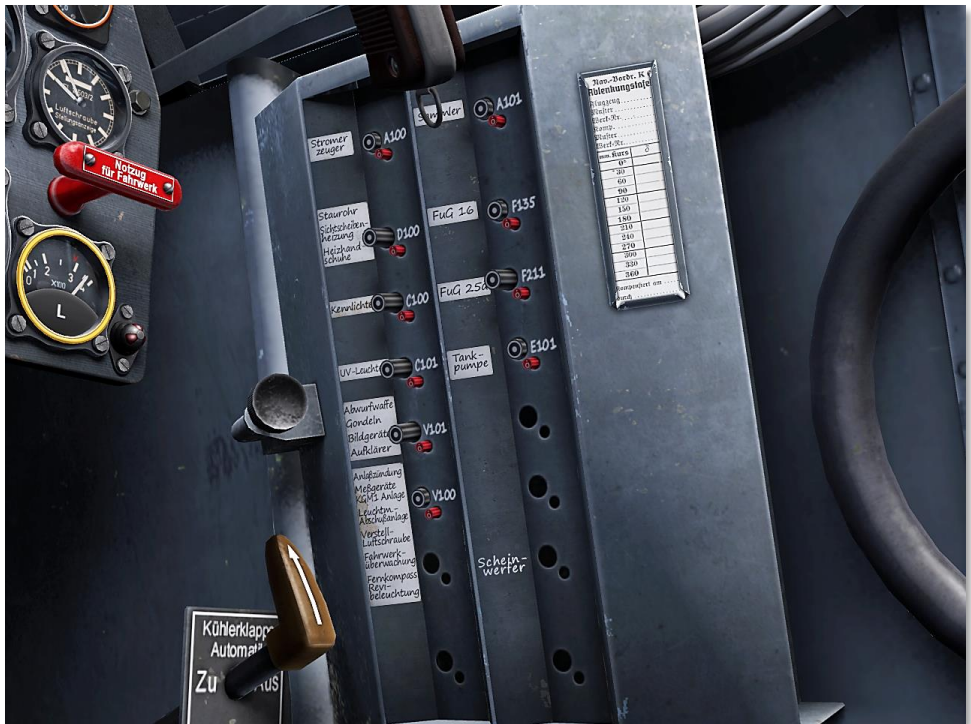
Рисунок 44: Панель АЗС в кабине пилота
