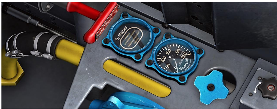
Рисунок 46: Индикатор подачи кислорода и кислородный манометр
