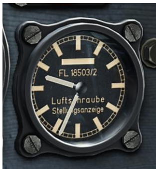
Рисунок 81: Индикатор шага винта в положении 9:34
