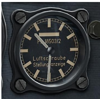
Рисунок 33: Индикатор шага винта в положении 10:30 или 38 градусов
