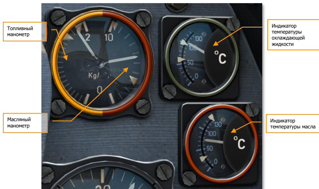
Рисунок 79: Топливо-масляный манометр и указатели температуры охлаждающей жидкости и масла
