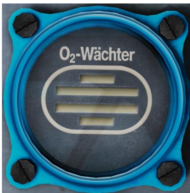
Рисунок 94: Индикатор подачи кислорода
