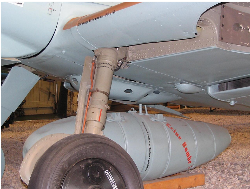
Рисунок 4: Основная стойка шасси Bf 109 G-2
