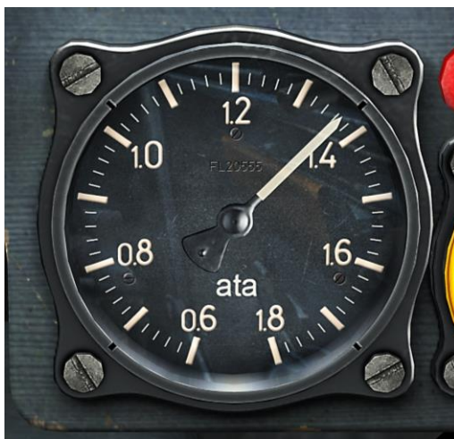
Рисунок 83: Индикатор давления наддува
