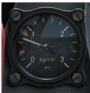
Рисунок 69: Манометр водно-метаноловой смеси
