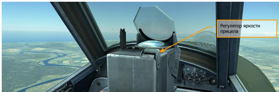
Рисунок 62: Регулятор яркости прицела
