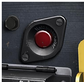
Рисунок 45: Кнопка аварийного обесточивания бортовой сети
