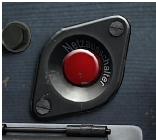
Рисунок 71: Кнопка аварийного обесточивания сети
