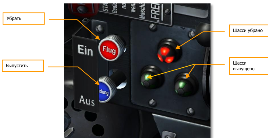
Рисунок 73: Кнопки управления и лампы положения шасси
