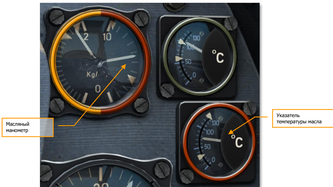
Рисунок 42: Масляный манометр (правая шкала) и указатель температуры масла
