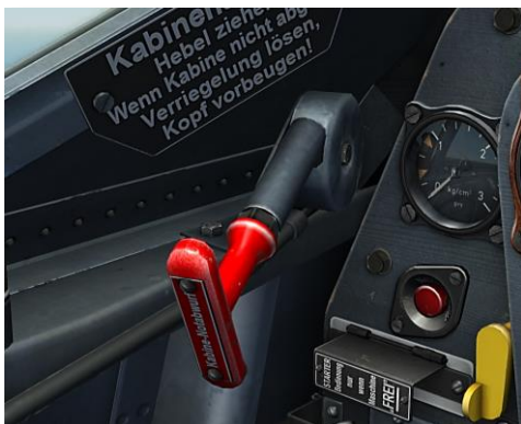
Рисунок 70: Ручка аварийного сброса фонаря
