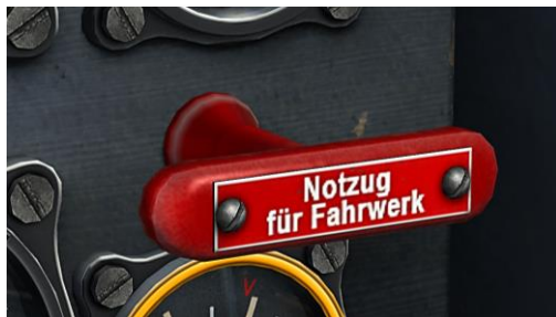
Рисунок 74: Ручка аварийного выпуска шасси
