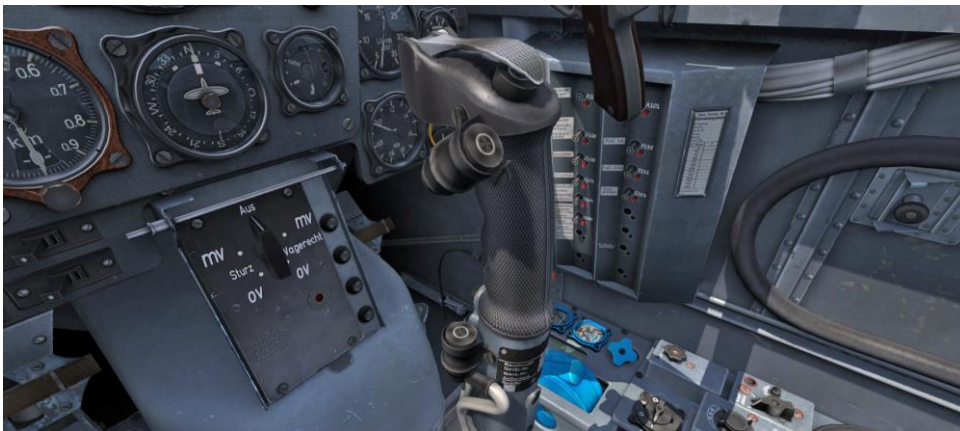
Рисунок 55: Ручка управления самолетом
