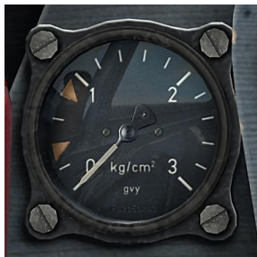
Рисунок 31: Манометр водно-метаноловой смеси
