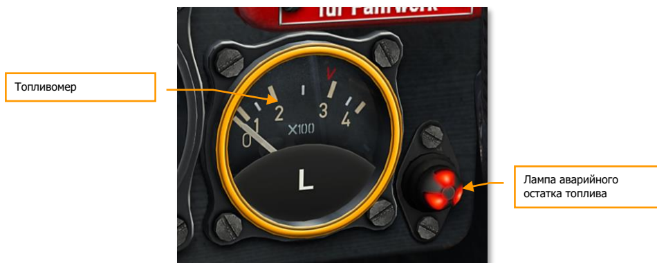
Рисунок 82: Топливомер и лампа аварийного остатка топлива
