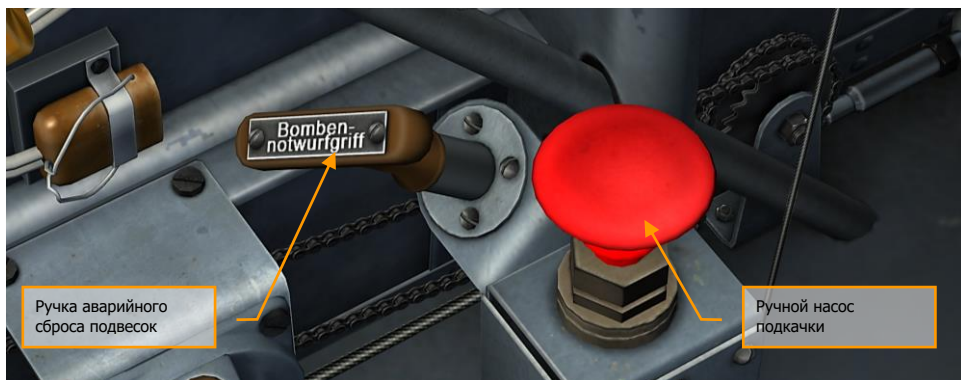
Рисунок 90: Ручка аварийного сброса подвесок и ручной насос подкачки
