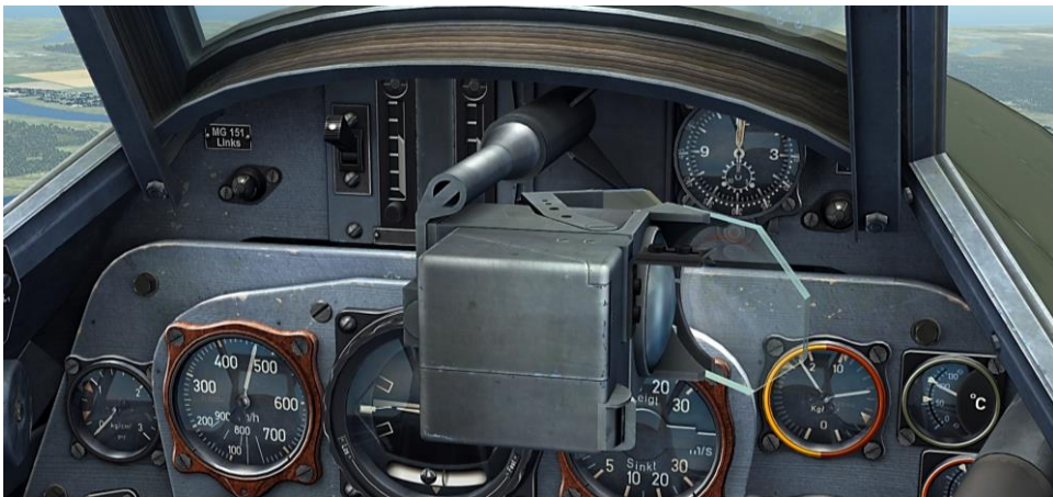
Рисунок 63: Прицел Rev 16B в убранном положении
