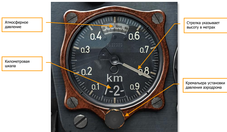
Рисунок 77: Высотомер
